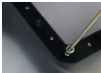
⑧ フレームをレジンバットにはめ、ネジを締めます。 ※ ネジは対角に締めます。
