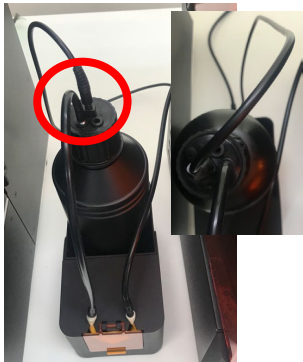
④ ポンプユニットとボトルキャップをケーブルで接続します。 これでPump & Fill 自動レジン供給フィーダーの取り付けは完了です。
