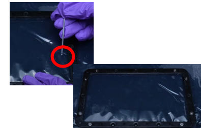
⑥レンチの先端を使用して、ネジ穴を空け、ネジ止めをします。(ネジは対角に止めます)
