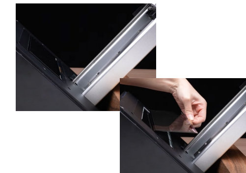
本体を傾けて、LCDを押し出します。
