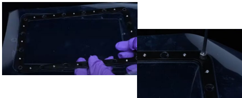
⑦レジンバットに合わせて残りのネジを止めます。(ネジは対角に止めます)
