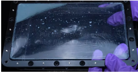
①レジンバットを清掃し、裏面にしてネジを取り外し、レジンバットから取り外します。
