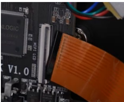
ケーブルを取り外します。
