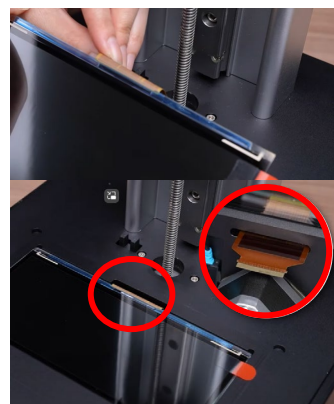
緑面を下にしてLCDを嵌めます。(ケーブルを挟まないように差込口を通してください。)
