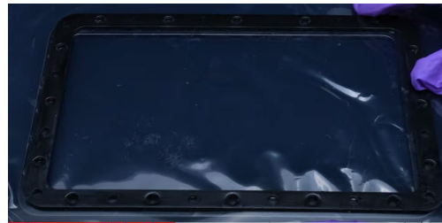
⑤新品のフィルムをプレートで挟みます。(光沢のある面を造形面になるようにしてください)
