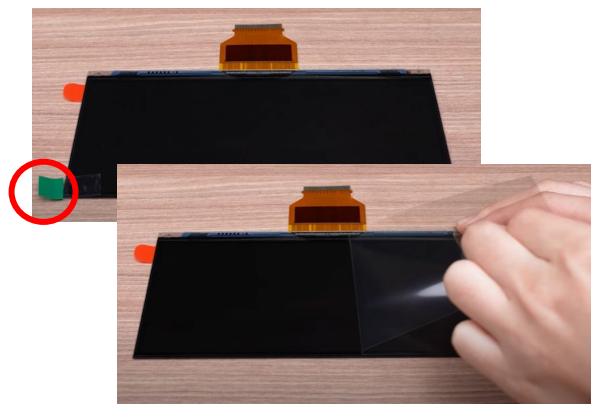
新品のLCDの緑面の保護フィルムを剥がします。
