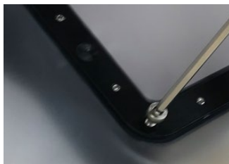
⑧ フレームをレジンバットにはめ、ネジを締めます。 ※ネジは対角に締めます。
