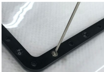
⑦ フィルムがたわまない様注意しつつネジを締めます。 ※ネジは対角に止めます
