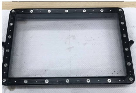
① レジンバットを清掃します。
