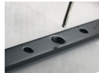
⑥ 新しいフィルムをフレームに挟みます。ネジ穴から穴を開けます。 ※フィルムがたわみすぎないように注意してください。 ※フィルムは光沢の強い面が造形物側になる様注意してください。
